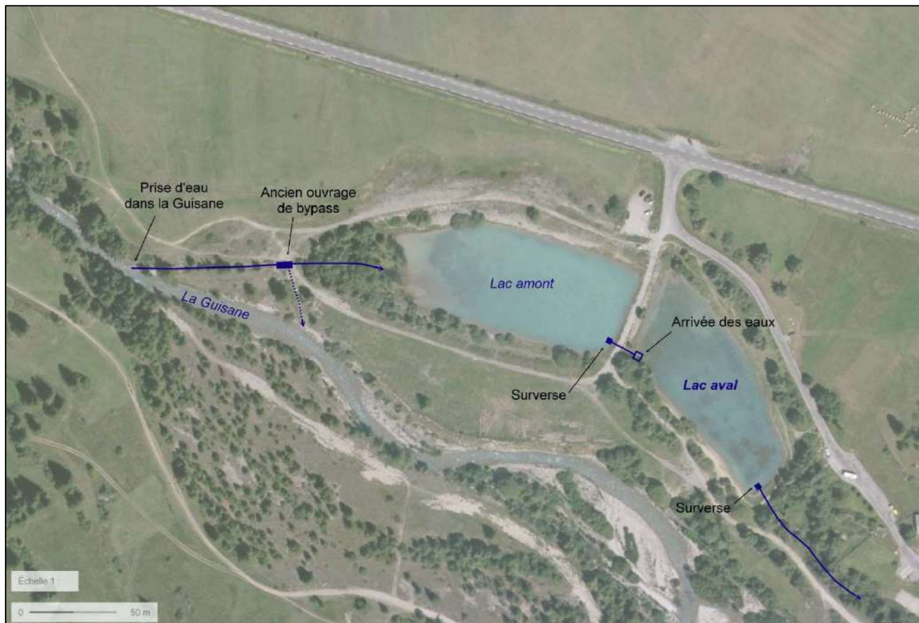
Figure 11 : Fonctionnement hydraulique du lac (source : Géoportail)
