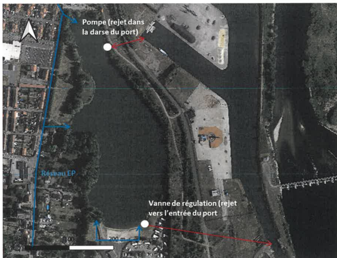
Figure 7 : Fonctionnement hydraulique du plan d'eau de Givet
