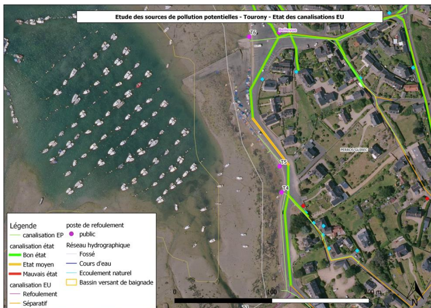
Figure 40 : Localisation des sources de pollution potentielles affectant le secteur Port de Ploumanac'h Est et état des canalisations EU – source : Orthophotoplan, SAGE BL, LTC – Conception : SAGE BL – mars 2021
