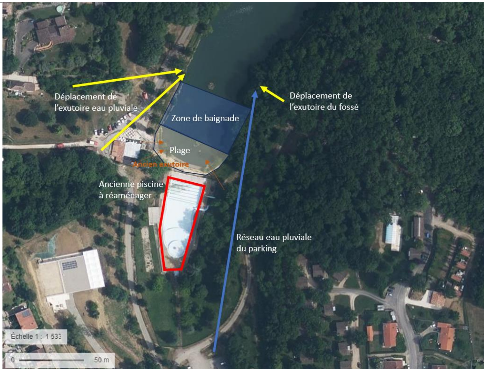
Figure 10 : Schéma de principe de l'installation de la zone de baignade future
