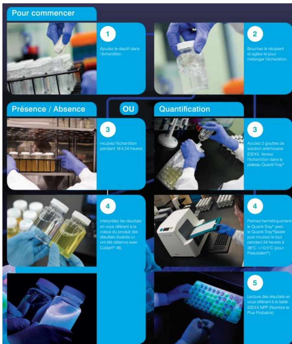
Figure 34 : Protocole d'analyse par méthode Colilert (source : IDEXX)
