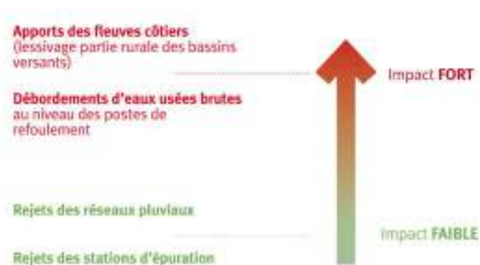
Figure 59 : Hiérarchisation des sources de pollution terrigène – Projet Life Environnement Mareclean SMBCG-IRH Ingénieur Conseil et Groupe IRH Environnement
