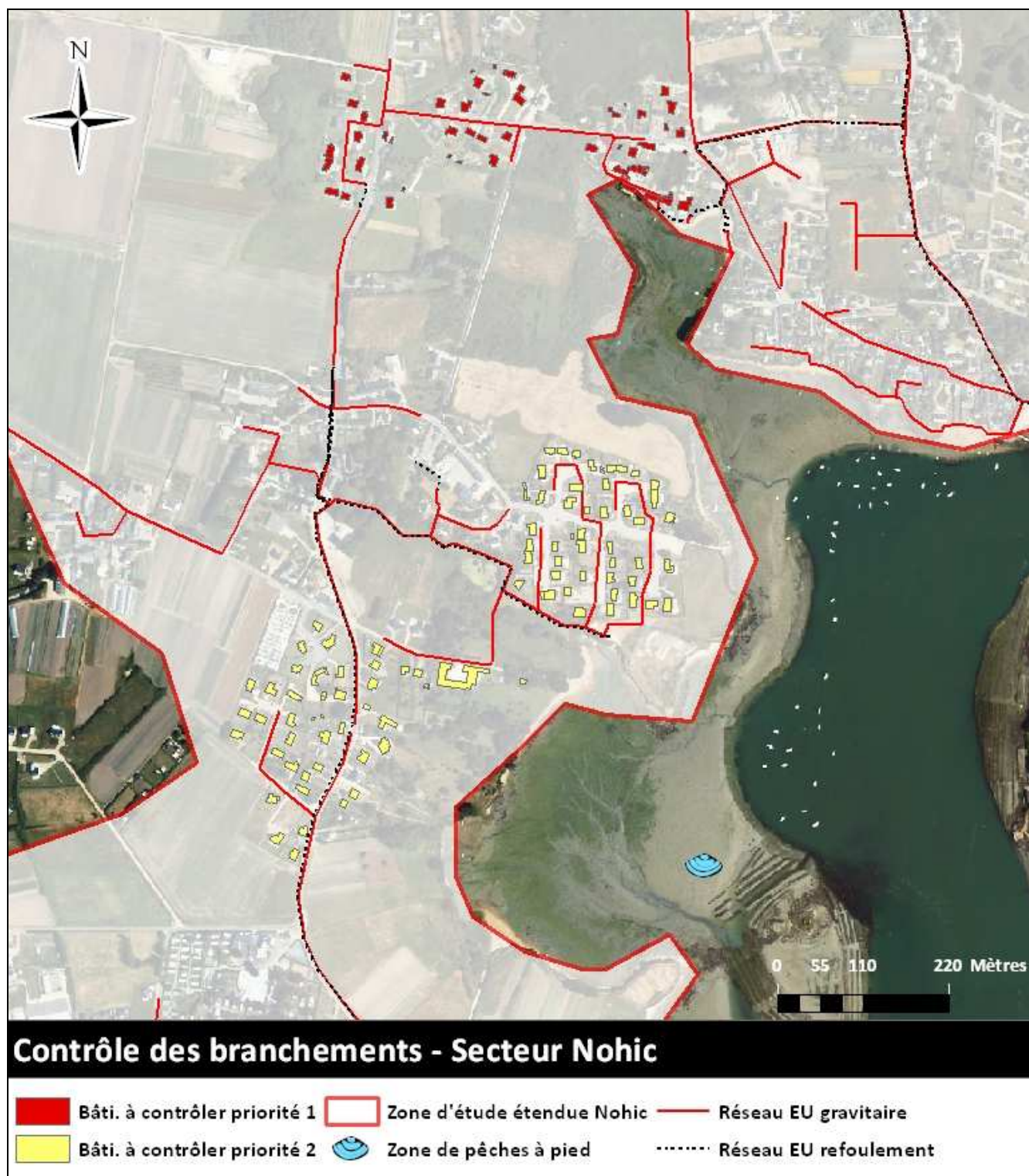
Figure 92 : Contrôle des branchements (destination des eaux usées)
