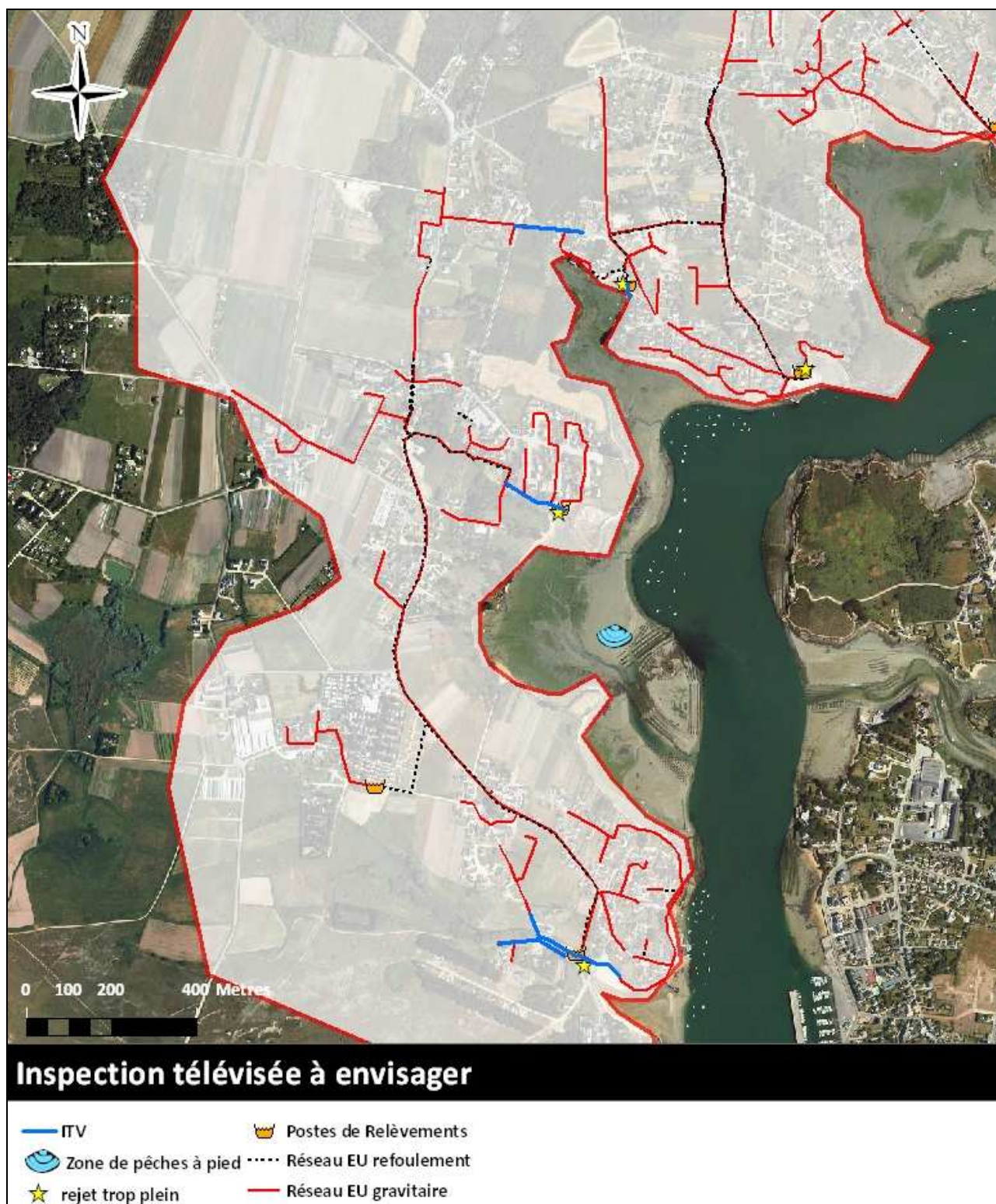
Figure 88 : Portions de réseau à inspecter
