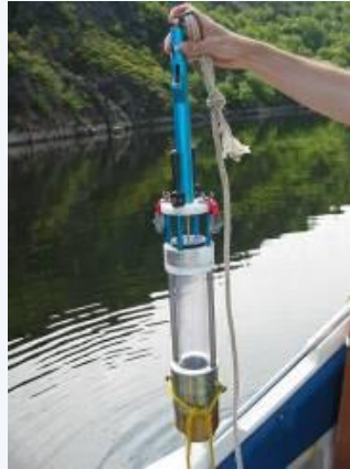
Figure 70: Carottier à main UWITEC (Source : ATHOS Environnement)
