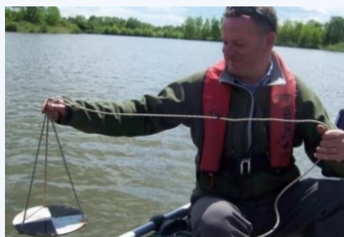
Figure 60 : Photographie du disque de Secchi (Source : ATHOS Environnement)
