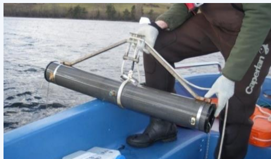
Figure 62 : Exemple de bouteille fermante utilisée pour les prélèvements d'eau (Source : ATHOS Environnement)
