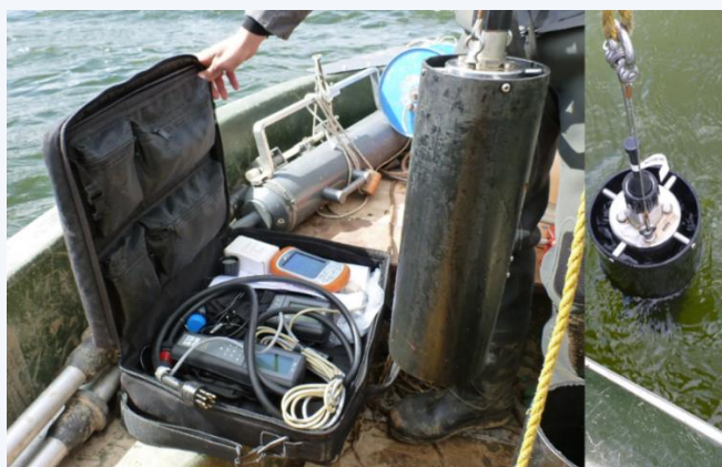
Figure 64 : Photographie de la sonde BBe fluorométrique (Source : ATHOS Environnement)
