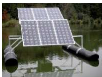
Exemple d'aérateur mécanique solaire et mélangeur mécanique éolien
