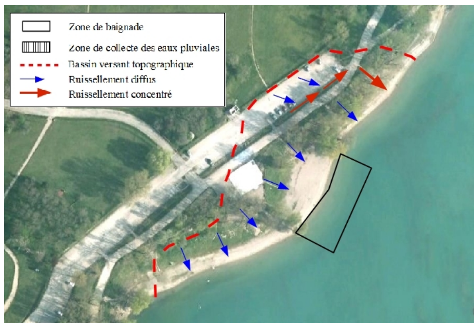
Illustration 22: sens d'écoulement et degré de concentration des ruissellements de surface, plage de la Baraka- fond photo Google Earth
