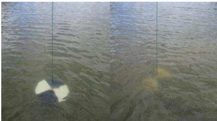
Figure 35 : Mesure de transparence au disque de Secchi (illustration)
