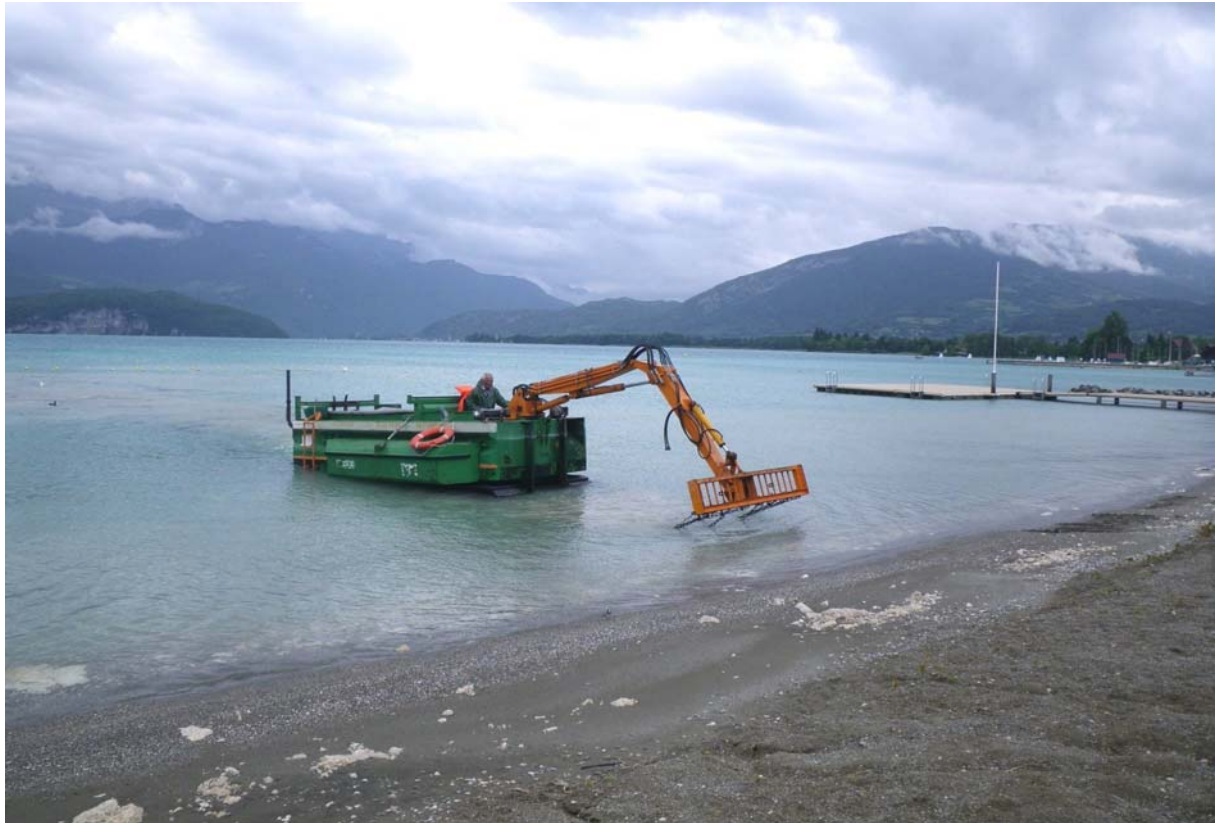
Figure 19 : Engin de hersage permettant le traitement contre la puce du canard – Intervention du 27/05/2011 sur la plage municipale de Sevrier.
