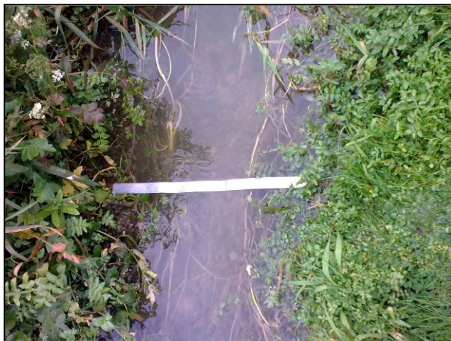
Photo 3 : Mesure de débit de l'exutoire 2
