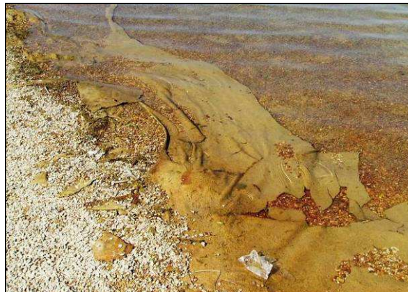
Photo 1 : Géotextile apparent sur la plage du plan d'eau de Torcy
