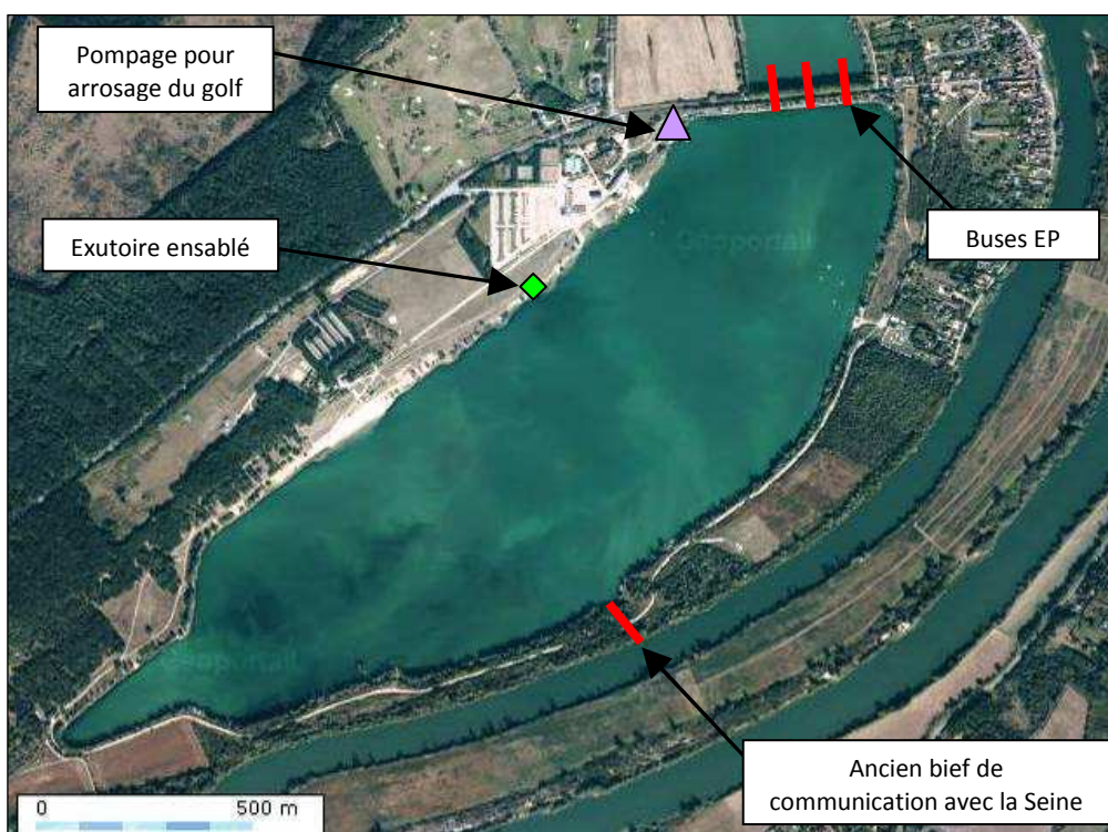
Figure 4 : Ouvrages hydrauliques du plan d'eau de la base de loisirs
