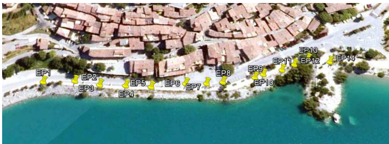
Illustration 3 : Localisation des exutoires pluviaux de Bauduen
