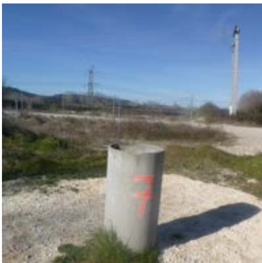
Piézomètre (P27) identifié à l'ouest du plan d'eau
