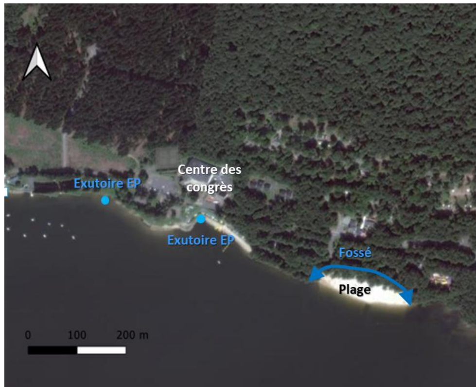
Figure 42 : Localisation des exutoires d'eaux pluviales à proximité de la zone de baignade (source : IRH, 2021)
